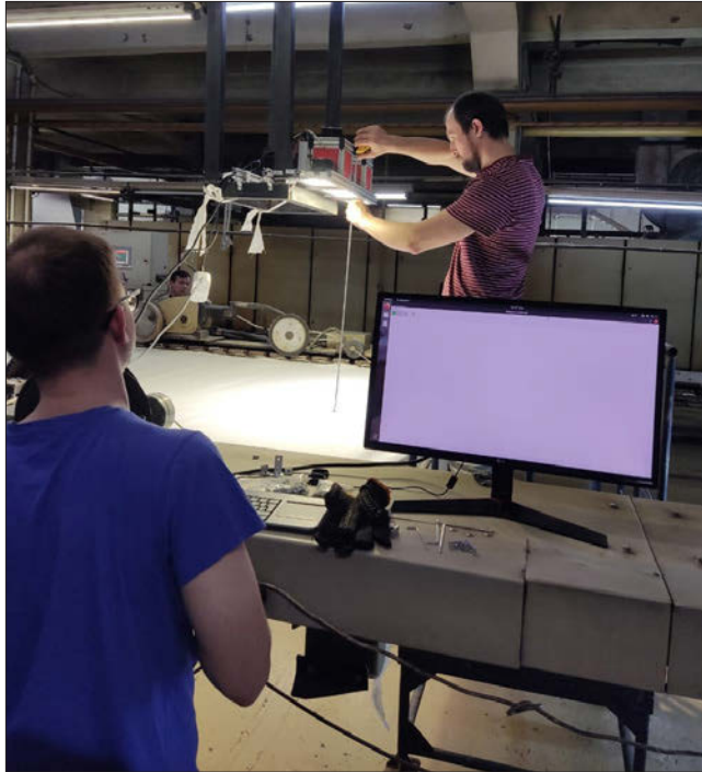
▲ Монтаж программно-аппаратного комплекса по обнаружению дефектов на текстильных материалах на Тейковском УБК для контроля процесса ткачества в реальном времени, совместная разработка ивановского и питерского политехов.
