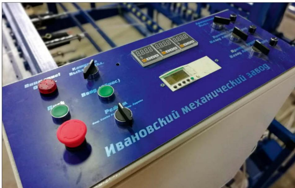
предназначена для производства высокопрочных композиционных профилей на основе углеродного волокна и углеродной ткани – новый пресс с конвейерной подачей.
